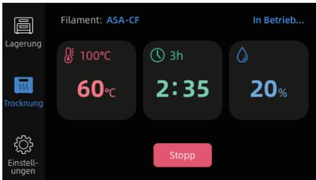
Das Material und die entsprechende Trocknungszeit und -temperatur kann auch von den Anwendern festgelegt werden.
